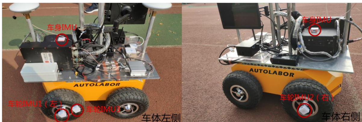
图 5-9 传感器安装位置示意（多个 MEMS-IMU）
