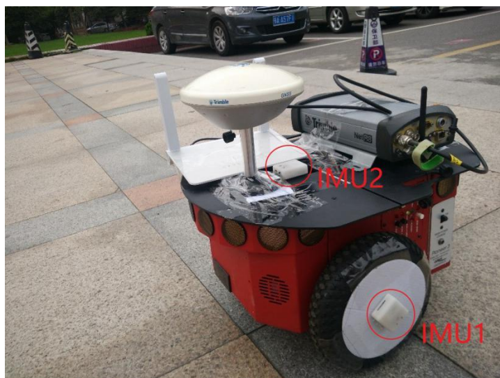
图 5-1 传感器安装位置示意 (单个 MEMS-IMU)
